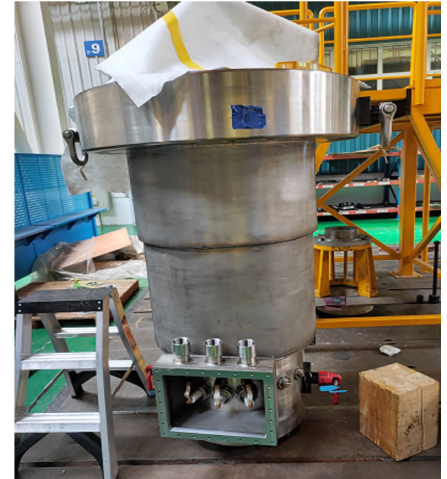
主泵电机组装
